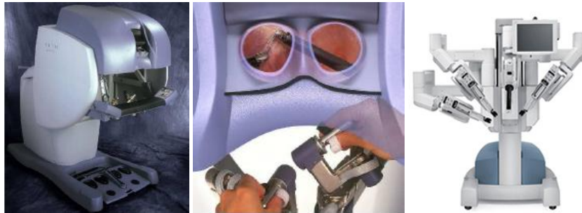
Figure 1.8. Le système Da Vinci : de gauche à droite, la console maître, le détail de l'interface de commande, les manipulateurs esclaves.
