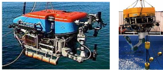
Figure 1.7. Exemple d'utilisation d'un robot embarqué sur un véhicule sous marin, à gauche image du sous marin JASON [SAY 95], à droite, image du sous marin expérimental VORTEX développé par l'Ifremer 6 de Toulon.
